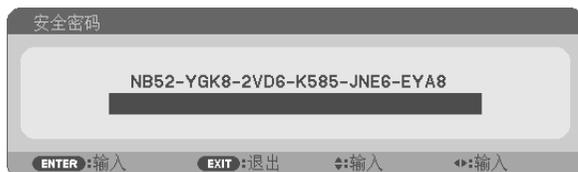
3. 输入正确的密码，然后按 **ENTER** 键。投影机将显示出影像。
