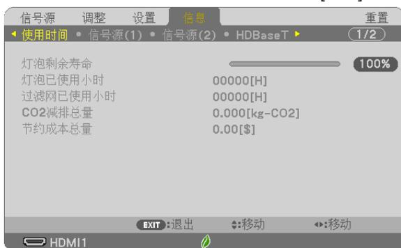
[本次使用过程中CO2的减排量] 表示从开机后即切换为节能模式到关机时止的 CO<sub>2</sub> 减排量。[本次使用过程中CO2的减排量] 消息将在关机时出现的 [关机/确定?] 消息中显示。
