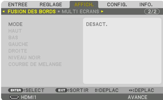
Ceci permet de régler les bords (limites) de l'écran de projection lors de la projection de vidéos à haute résolution à l'aide d'une combinaison de plusieurs projecteurs dans les positions haut, bas, gauche et droite.
