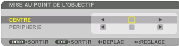
Appuyez sur les boutons ◀▶ pour ajuster la mise au point. Autrement dit, appuyez et maintenez le bouton CTL, puis appuyez sur le bouton VOLUME/FOCUS +/- sur la télécommande.
