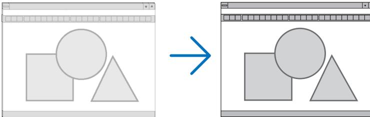
**FASE** ..... Usate questa voce per regolare la fase dell'orologio o per ridurre il disturbo video, le interferenze dei punti o le interferenze acustiche. (Evidente quando una parte dell'immagine brilla).
