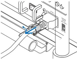
**2. Premete il morsetto del fermacavo di alimentazione per aprirlo abbastanza da potere estrarre il cavo di alimentazione.**
