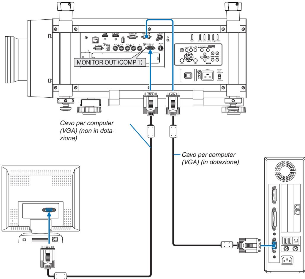
Potete collegare un monitor separato, esterno al proiettore per visualizzare contemporaneamente sul monitor l'immagine analogica del computer in fase di proiezione.
