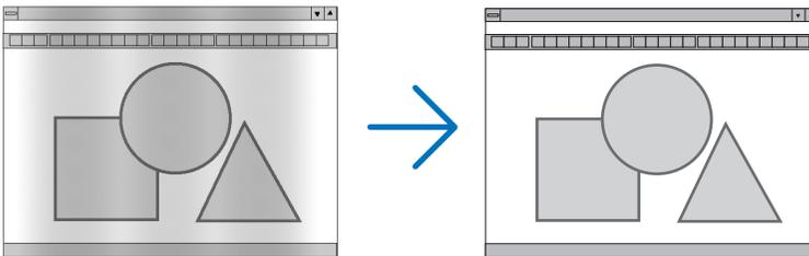
**OROLOGIO** ..... Usate questa voce per la sintonizzazione di precisione dell'immagine del computer o per rimuovere bande verticali che possono apparire. Questa funzione consente di regolare le frequenze dell'orologio che eliminano le bande orizzontali nell'immagine.
