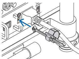
2. **Usate il fermacavo di alimentazione per bloccare il cavo di alimentazione.**
