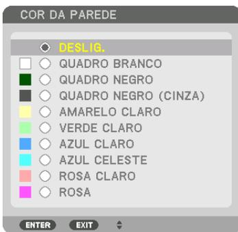
Esta função permite a rápida correção adaptável da cor em aplicativos nos quais a tela não é branca.
