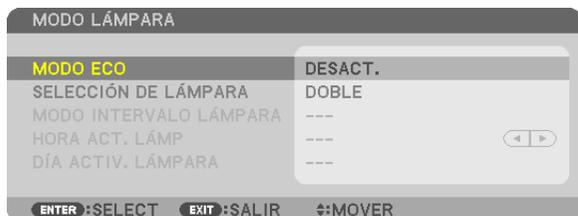
Este sistema de lámpara dual proporciona una vida útil de la lámpara más prolongada o un mayor brillo o una lámpara extra (lámpara de vida útil prolongada).
