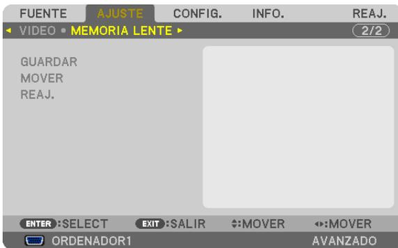
Esta función sirve para almacenar los valores ajustados para cada señal de entrada cuando se utilizan los botones LENS SHIFT, ZOOM y FOCUS del proyector. Los valores ajustados podrán aplicarse a la señal seleccionada. Con ello se eliminará la necesidad de ajustar el desplazamiento de la lente, el enfoque y el zoom a la hora de seleccionar la fuente.
