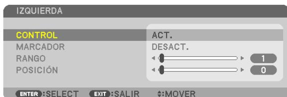
Cada [ARRIBA], [ABAJO], [IZQUIERDA], [DERECHA] y [NIVEL DE NEGROS] posee su propio [CONTROL], [MARCADOR], [RANGO] y [POSICIÓN]. Activar [CONTROL] hará que [MARCADOR], [RANGO] y [POSICIÓN] estén disponibles.
