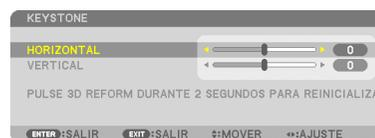
2. Pulse el botón **▼** para seleccionar [VERTICAL] y a continuación use **◀** o **▶** de modo que los laterales izquierdo y derecho de la imagen proyectada estén en paralelo.
