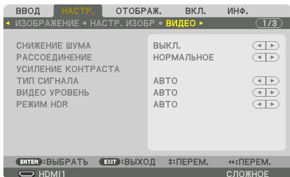
**Использование функции снижения шума [СНИЖЕНИЕ ШУМА]**
