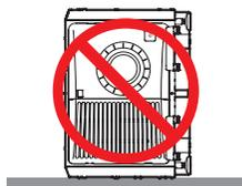
Интенсивное световое излучение из объектива, такое как лазерное, может привести к неисправности. Если изображения в данный момент не проецируются, рекомендуется закрыть затвор объектива.
