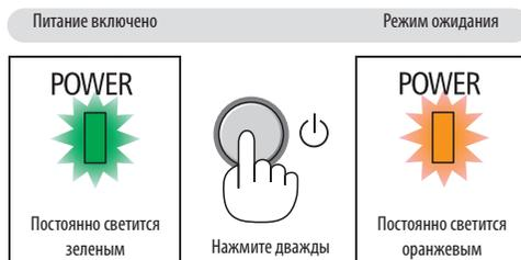
3. После переключения проектора в режим ожидания приведите в выключенное положение переключатель питания проектора ([1]), а затем переключатель питания источника света ([2]).
