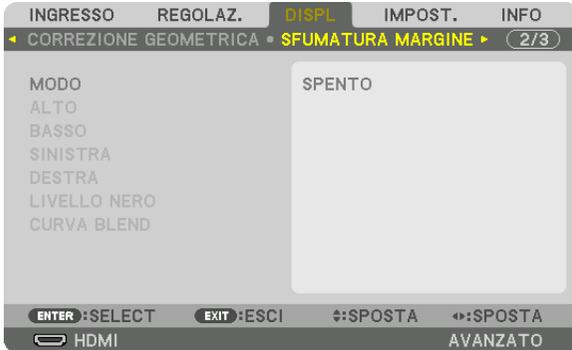
Ciò consente di regolare i bordi (confini) dello schermo di proiezione quando si proiettano video ad alta risoluzione mediante una combinazione di più proiettori nelle posizioni alta, bassa, sinistra e destra.
