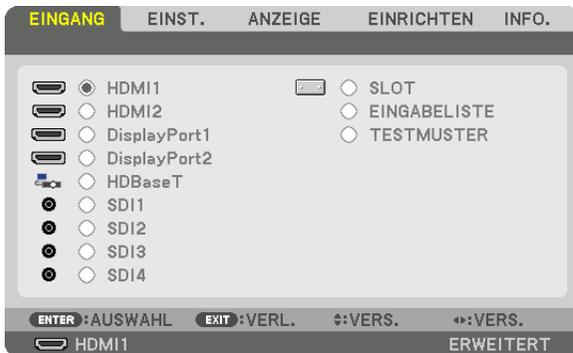
Drücken Sie die ▼/▲-Tasten, um den Zieleingangsanschluss anzupassen und drücken Sie dann die ENTER-Taste, um den Eingang umzuschalten. Zum Löschen der Menüanzeige des [EINGANG]-Bildschirms drücken Sie die MENU oder EXIT Taste.
