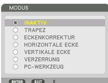
5. Drücken Sie die ▼-Taste, um mit der [ECKENKORREKTUR] auszurichten und drücken Sie die ENTER-Taste.
