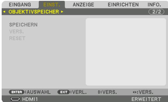
Diese Funktion dient zur Speicherung von eingestellten Werten für die einzelnen Eingangssignale, wenn Sie die Tasten LENS SHIFT, ZOOM und FOCUS des Projektors benutzen. Eingestellte Werte können auf das ausgewählte Signal angewendet werden. Damit wird die Einstellung von Objektivversatz, Fokus und Zoom bei der Auswahl der Quelle überflüssig.
