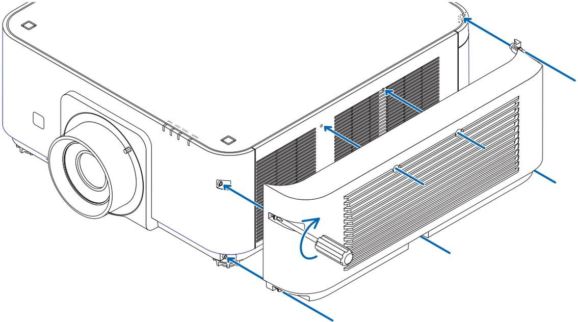
\* При использовании нормальной горизонтальной ориентации, обязательно снимите защитную крышку. Для удаления открутите 7 винтов (повернув против часовой стрелки).
