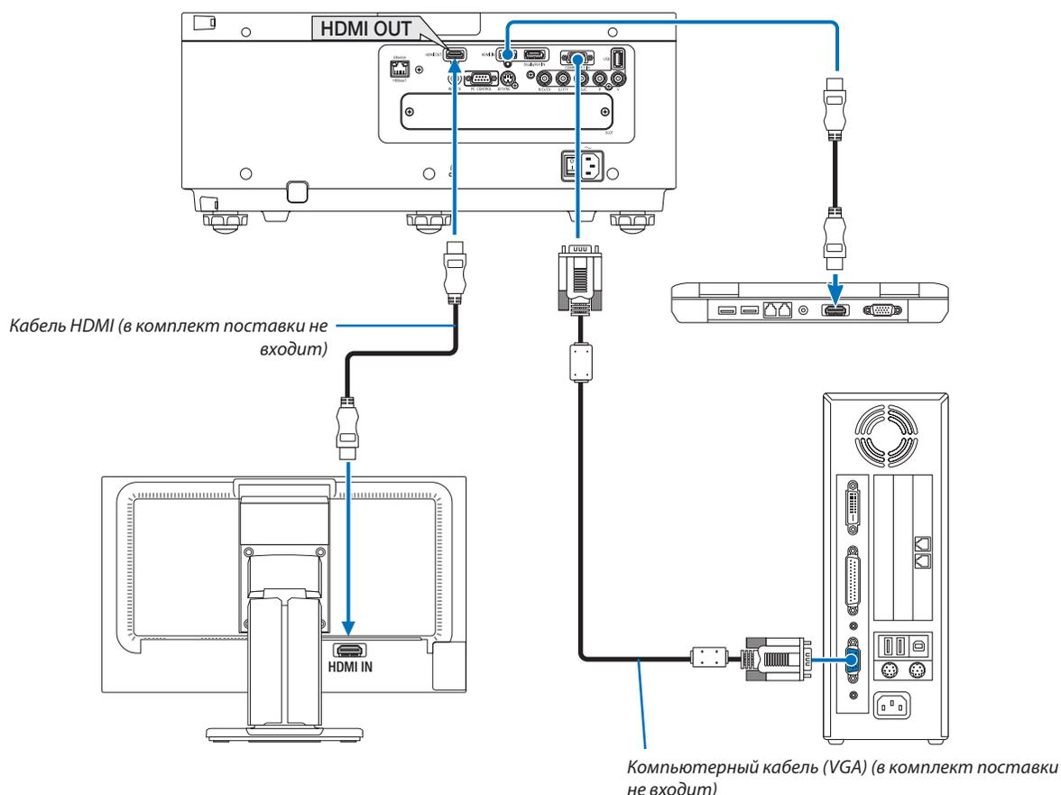
К проектору можно подключить отдельный внешний монитор для параллельного просмотра на мониторе проецируемого компьютерного аналогового изображения.
