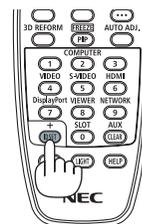
Если проектором можно управлять, используя текущий ID пульта дистанционного управления, то на экране отобразится [АКТИВНЫЙ]. Если проектором нельзя управлять, используя текущий ID пульта дистанционного управления, то на экране отобразится [НЕАКТИВНЫЙ]. Чтобы управлять неактивным проектором, задайте ID элемента управления (Контроль ID), используемого для проектора, выполнив следующую процедуру (Шаг 3).
