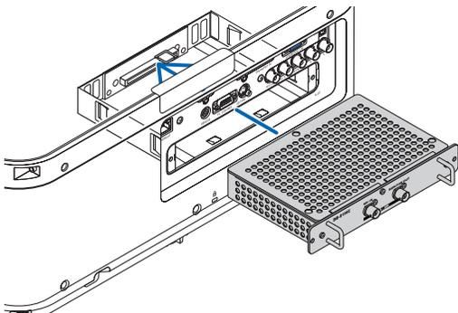
**4. Затяните два винта с обеих сторон слота.**
