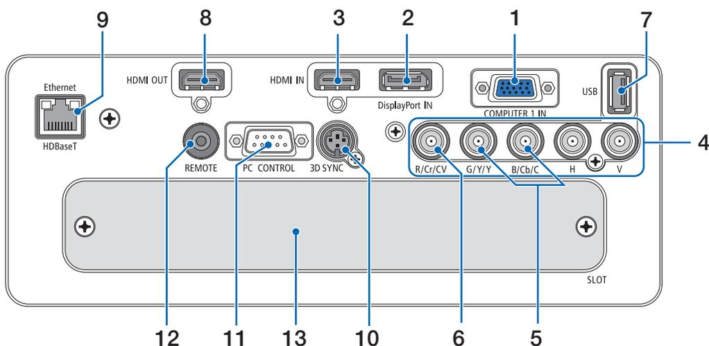
**1. COMPUTER 1 IN/ Компонентный входной разъем (15-штыревой миниатюрный разъем типа D)**
