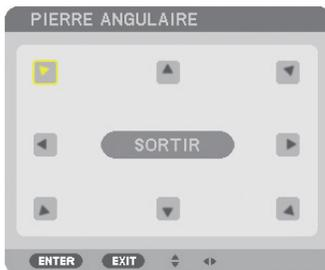
Cette option vous permet de corriger les distorsions trapézoïdales.
