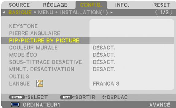
L'élément de menu [PIP/PICTURE BY PICTURE] possède les 3 options suivantes : MODE, POSITION, et SOURCE. Utilisez les touches ▲ ou ▼ pour sélectionner [MODE], [POSITION] ou [SOURCE] et appuyez sur la touche ENTER.
