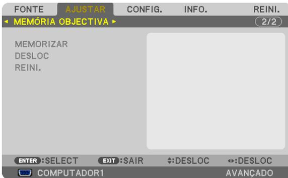
Esta função serve para armazenar os valores ajustados para cada sinal de entrada utilizando os botões LENS SHIFT, ZOOM e FOCUS do projetor. Os valores ajustados podem ser aplicados ao sinal que seleccionou. Isto eliminará a necessidade de ajustar a deslocação da lente, a focagem e o zoom aquando da selecção da fonte.
