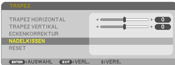
**3. Drücken Sie entweder die ▲ oder ▼-Taste, um eines von oben, unten, links, rechts auszuwählen, und drücken Sie dann entweder die ◀ oder ▶-Taste, um die Kissenverzerrung neu zu formen.**
