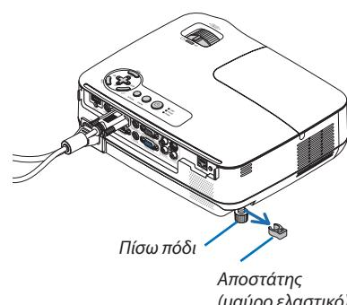
**ΣΗΜΕΙΩΣΗ:** Αφού χρησιμοποιήσετε τη συσκευή προβολής, προσαρμόστε τον αποστάτη στο πίσω πόδι.
