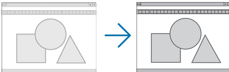
**ΦΑΣΗ** ..... Χρησιμοποιήστε αυτό το στοιχείο για να ρυθμίσετε τη φάση του ρολογιού ή για να μειώνετε το θόρυβο του βίντεο, τις κουκκίδες ("χιόνια") ή τις παρεμβολές σημάτων. (Αυτό ισχύει όταν τμήμα της εικόνας σας εμφανίζεται να τρεμοπαίζει.)
