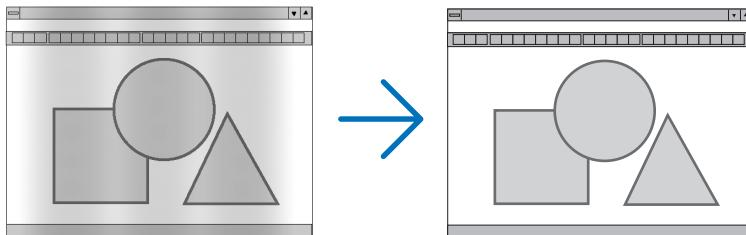
**ΡΟΛΟΪ** ..... Χρησιμοποιήστε αυτό το στοιχείο για να ρυθμίσετε την εικόνα του υπολογιστή ή για να αφαιρέσετε τυχόν κάθετες λωρίδες που μπορεί να εμφανίζονται. Η λειτουργία αυτή ρυθμίζει τις συχνότητες του ρολογιού που μειώνουν τις οριζόντιες λωρίδες της εικόνας.
