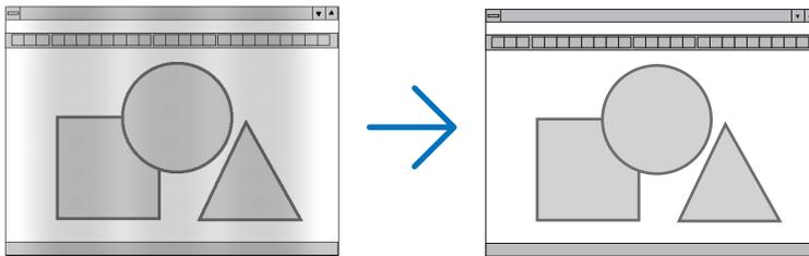
**RELÓGIO** ..... Use este item para afinar a imagem do computador ou para remover quaisquer bandas verticais que possam aparecer. Esta função ajusta as frequências do relógio que eliminam as bandas horizontais da imagem. Este ajuste pode ser necessário quando ligar o seu computador pela primeira vez.
