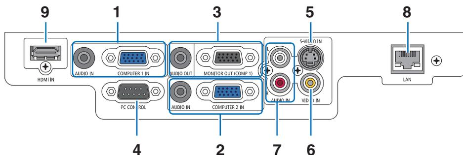
1. **Conector de entrada COMPUTER 1 IN/ Componente (Mini D-Sub 15 Pinos)**
