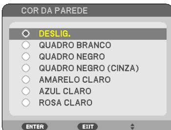
Esta função permite uma rápida correcção de adaptação de cor em aplicações em que o material do ecrã não é branco.
