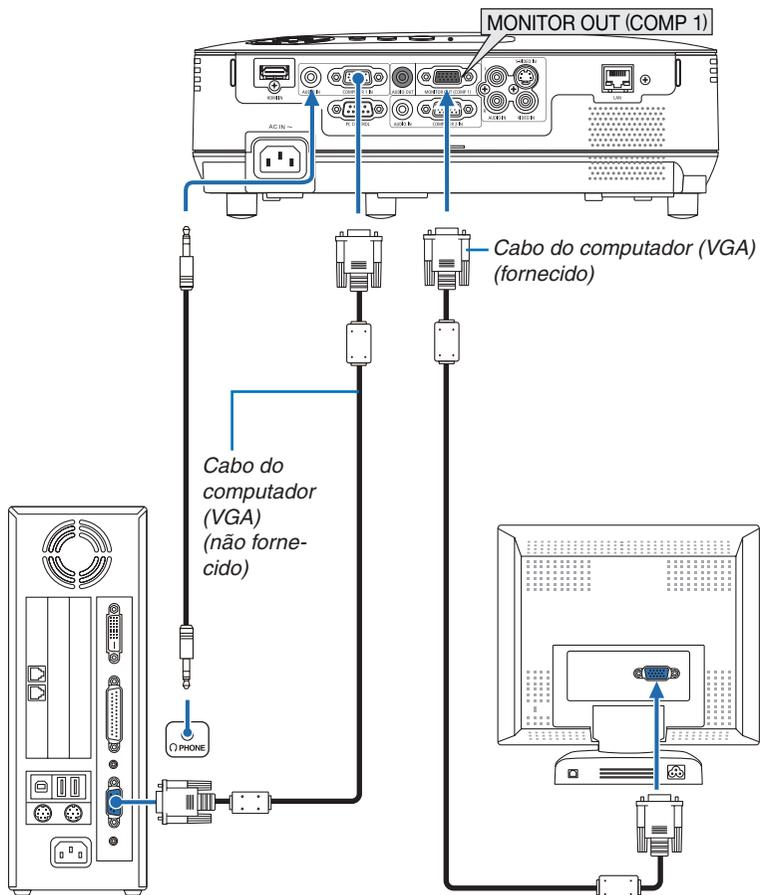
Pode ligar um monitor externo em separado ao seu projector, para ver simultaneamente num monitor a imagem analógica de computador que está a projectar.
