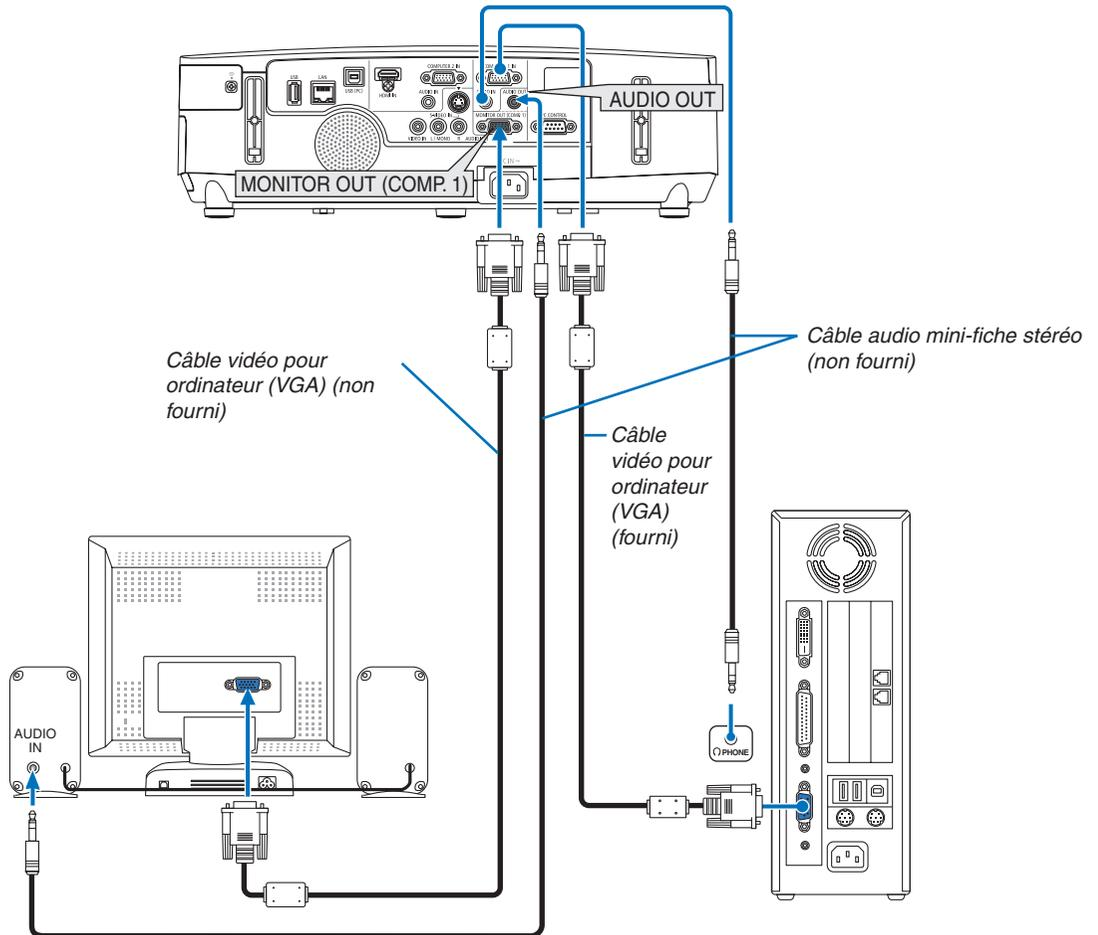
Un moniteur externe, séparé peut être connecté au projecteur pour visualiser simultanément sur un moniteur l'image analogique d'ordinateur en cours de projection.
