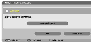
Cette option permet d'allumer/d'éteindre le projecteur et de changer de signal vidéo, ainsi que de sélectionner automatiquement le mode ÉCO à un instant particulier.
