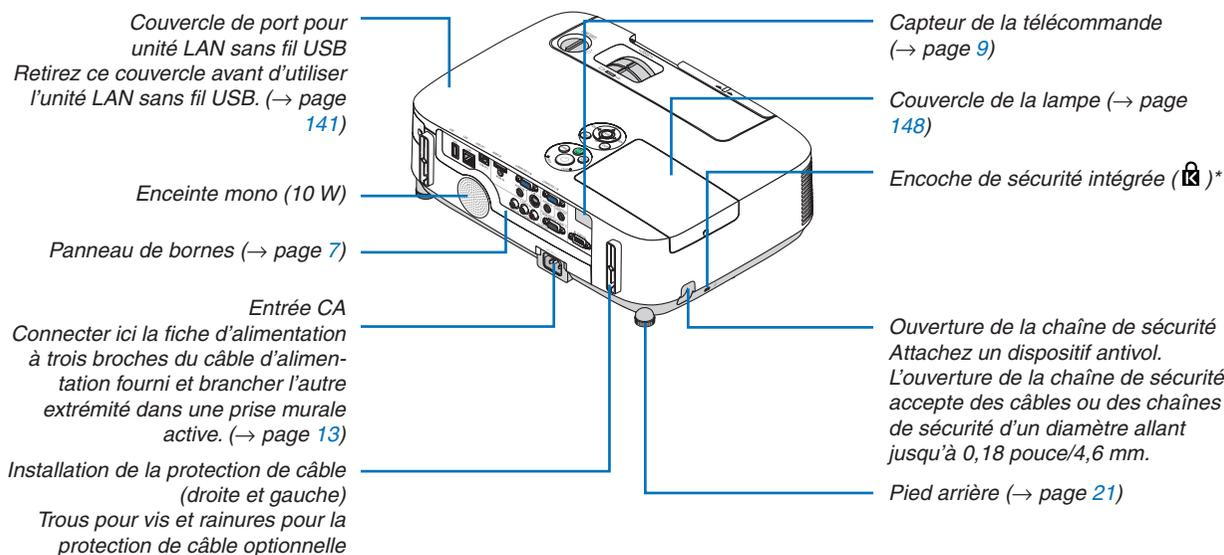
\* Cette encoche de sécurité est compatible avec le système de sécurité MicroSaver®.
