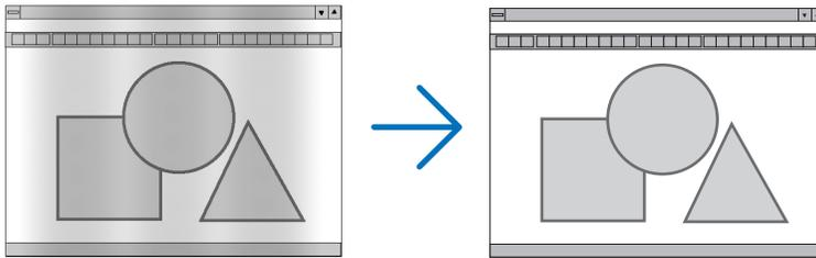
**HORLOGE**..... Utiliser cet élément pour régler avec précision l'image d'ordinateur ou pour supprimer les bandes verticales qui peuvent apparaître. Cette fonction ajuste les fréquences d'horloge qui suppriment le scintillement horizontal dans l'image.
