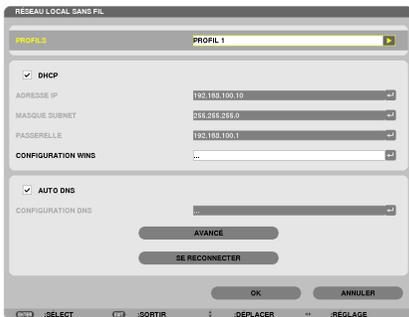
2. **Configurez les éléments PROFILS, DHCP, ADRESSE IP, MASQUE SUBNET ou autres si nécessaire.**
