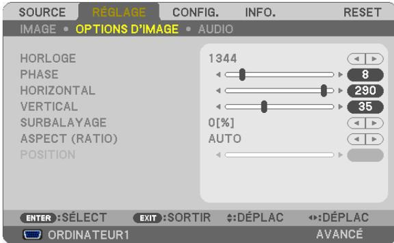
**Réglage de l'horloge et de la phase [HORLOGE/PHASE]**
