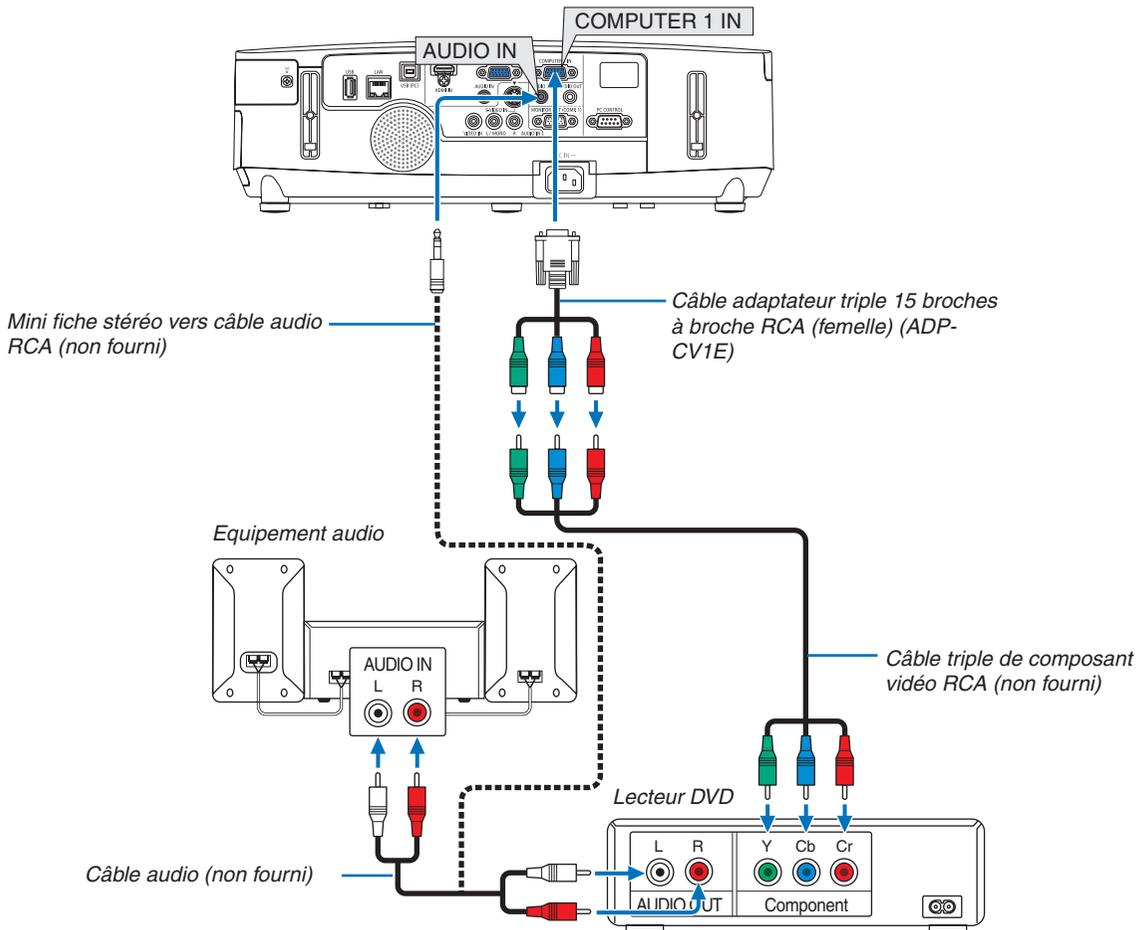
Un signal composant sera automatiquement affiché. Si ce n'est pas le cas, sélectionner dans le menu [CONFIG.] → [OPTIONS(1)] → [SÉLECTION DU SIGNAL] → [ORDINATEUR1] ou [ORDINATEUR2], puis cocher la touche Composant Radio.
