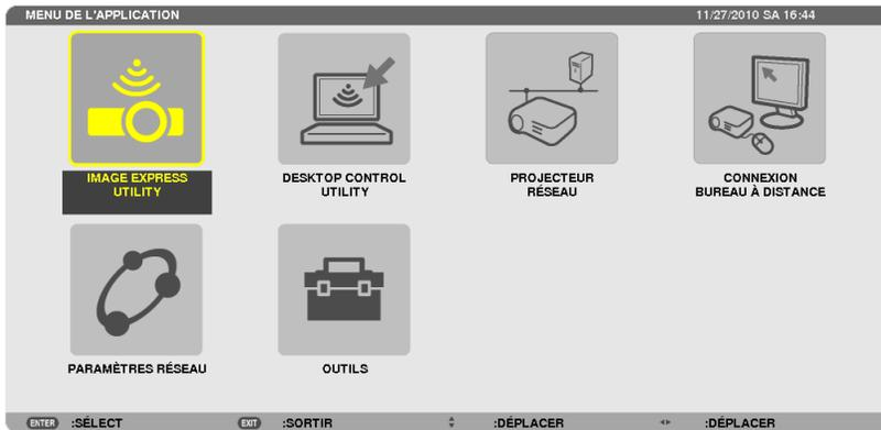
3. Dans le menu [RÉSEAU] utilisez le clavier sans fil pour sélectionner [CONNEXION BUREAU À DISTANCE].
