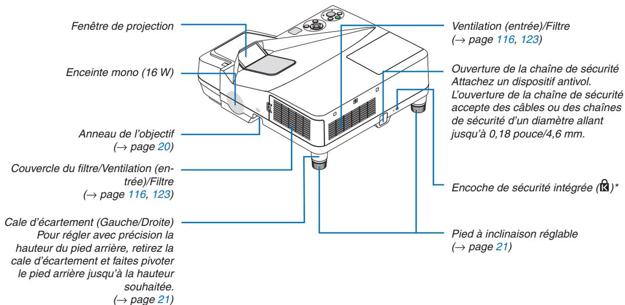
\* Cette encoche de sécurité est compatible avec le système de sécurité MicroSaver®.
