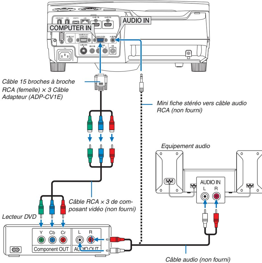
Un signal composant sera automatiquement affiché. Si ce n'est pas le cas, sélectionner dans le menu [CONFIG.] → [OPTIONS(1)] → [SELECTION DU SIGNAL] → [ORDINATEUR], puis cocher la touche Radio composant.
