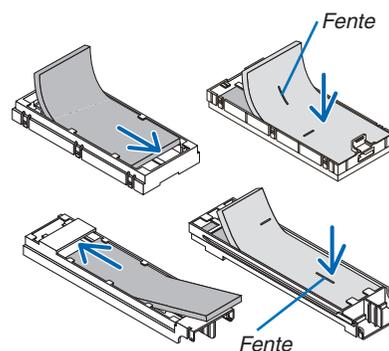
**6. Insérez le grand boîtier à filtre dans le boîtier du projecteur.**
