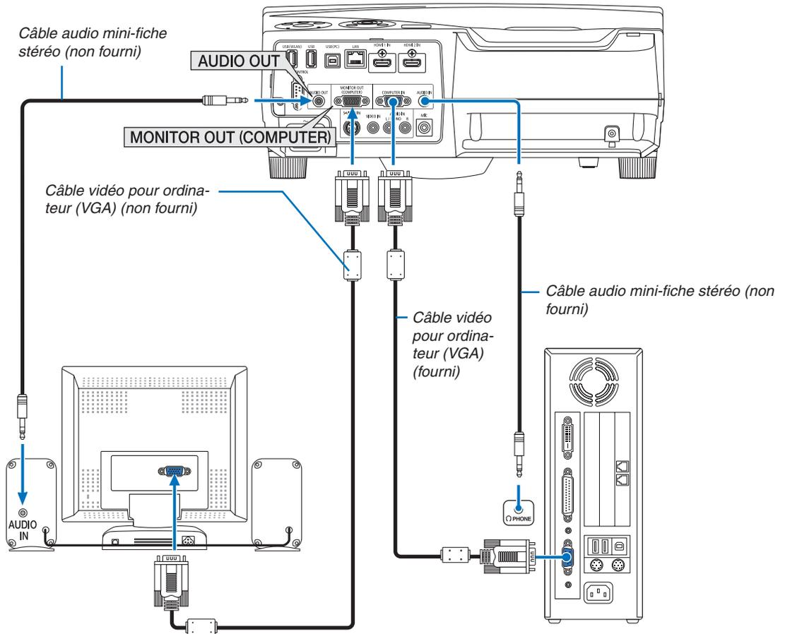
Un moniteur externe, séparé peut être connecté au projecteur pour visualiser simultanément sur un moniteur l'image analogique d'ordinateur en cours de projection.
