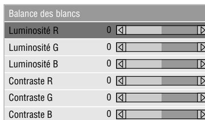
Utilisez la touche ◀ et ▶ pour régler la balance des blancs. La luminosité pour chaque couleur RGB est utilisée pour régler l'intensité du noir de l'écran. Le contraste pour chaque couleur RGB est utilisé pour régler l'intensité du blanc de l'écran.
