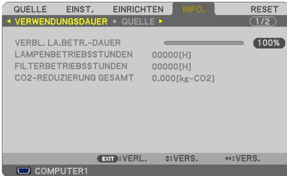
Die Meldung [CO<sub>2</sub>-REDUZIERUNGS-SESSION] zeigt die Menge der CO<sub>2</sub>-Emissionsreduktion in der Zeit zwischen dem Wechsel in die ECO-BETRIEBSART sofort nach dem Einschalten und dem Zeitpunkt des Ausschaltens an. Die Meldung [CO<sub>2</sub>-REDUZIERUNGS-SESSION] wird in der Meldung [STROM AUSSCHALTEN / SIND SIE SICHER?] beim Ausschalten angezeigt.
