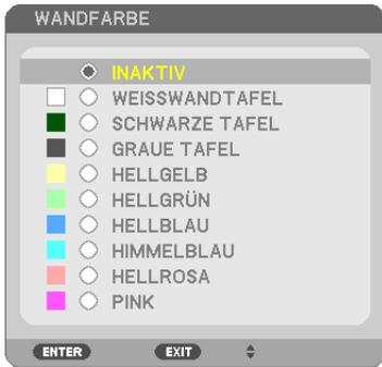
Diese Funktion ermöglicht eine schnelle, anpassungsfähige Farbkorrektur bei Verwendung eines Bildschirmmaterials, dessen Farbe nicht Weiß ist.
