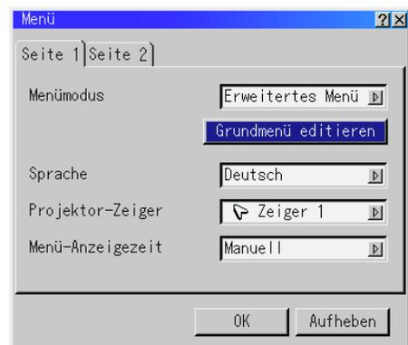
2. Heben Sie Ihre Auswahl mit den ▲ oder ▼ Tasten hervor und drücken Sie die Eingabetaste, um ein Prüfzeichen neben eine Option zu setzen. Dadurch wird die Funktion aktiviert. Drücken Sie die Eingabetaste noch einmal, um das Kontrollkästchen zu löschen.
