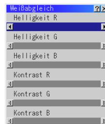
Stellen Sie mit den Wahl-tasten oder die Weißabgleich ein. Die Einstellung der Helligkeit für jede einzelne Farbe (RGB) dient der Einstellung des Bildschirm-Schwarzpegels. Die Einstellung des Kontrastes für jede einzelne Farbe (RGB) dient der Einstellung des Bildschirm-Weißpegels.
