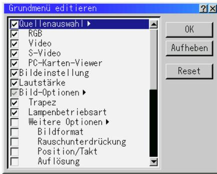
Wenn Sie eine Funktion mit einem Dreieck ▶ anwählen und die Eingabetaste auf der Fernbedienung oder am Projektorgehäuse drücken, können Sie mit dem entsprechenden Untermenü alle Funktionen aktivieren. Sie können eine Funktion innerhalb des Untermenüs auch ohne Setzen eines Prüfzeichens auf der Hauptmenü-Funktion einschalten.
