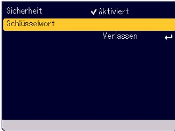
4. Wählen Sie durch Drehen des SELECT +/- Wahlschalters [Schlüsselwort] und drücken Sie dann die ENTER-Taste.
