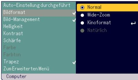
Mit dieser Funktion können Sie das für Ihr Quellenbild am besten geeignete Bildformat auswählen. Sie können das Bildformat-Fenster auch durch Drücken der "ASPECT"-Taste auf der Fernbedienung anzeigen lassen. (Siehe Seite G-8.)
