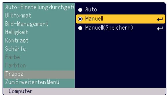
3. Wählen Sie durch Drehen des SELECT +/- Wahlschalters "Manuell" und drücken Sie dann die ENTER-Taste.
