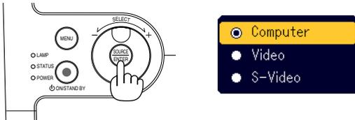
Drücken Sie kurz die SOURCE-Taste am Projektorgehäuse, um die Quellen-Liste anzeigen zu lassen. Bei jedem Drücken der SOURCE-Taste, werden die einzelnen Quellen-Bezeichnungen nacheinander hervorgehoben. Durch das Hervorheben einer Quellen-Bezeichnung wird nach einer Sekunde ein Sanduhr-Symbol angezeigt. Anschließend wird das Eingangssignal ausgewählt.
