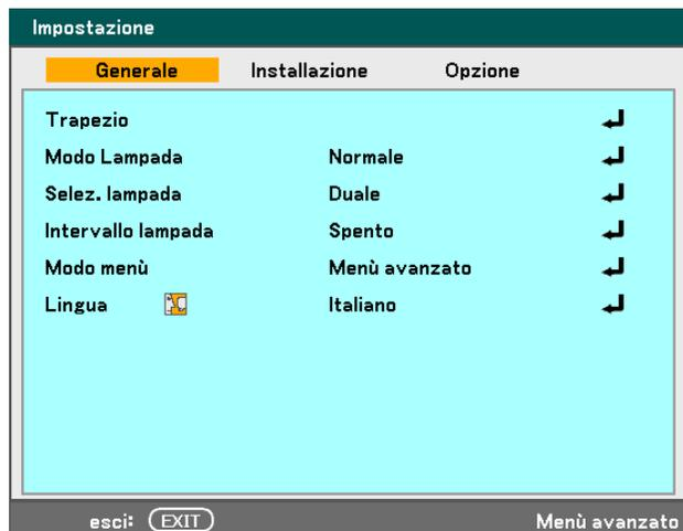
3. Dalla finestra della **Modo Lampada**, selezionare **Normale** o **Eco** mediante ▲ o ▼. Selezionare **OK** e premere **Enter**.
