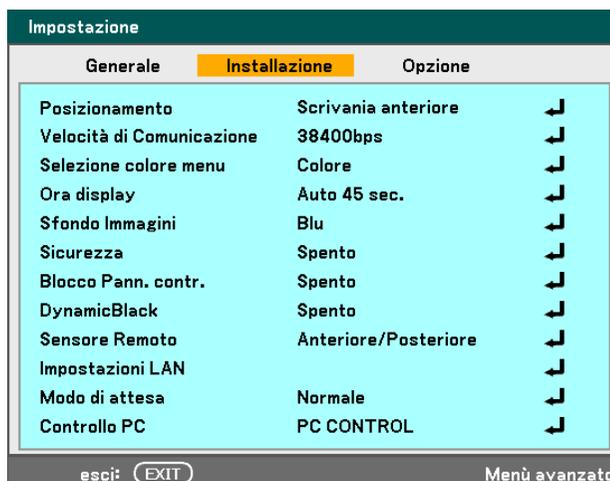
3. Viene richiesto di attivare la funzione di Sicurezza. Selezionare **OK** e premere **Enter**. Selezionare **Acceso** mediante il pulsante ▼.
