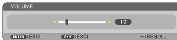
SUGGERIMENTO: quando non è visualizzato un menù, i tasti ◀ e ▶ sull'involucro del proiettore funzionano come controlli del volume.
