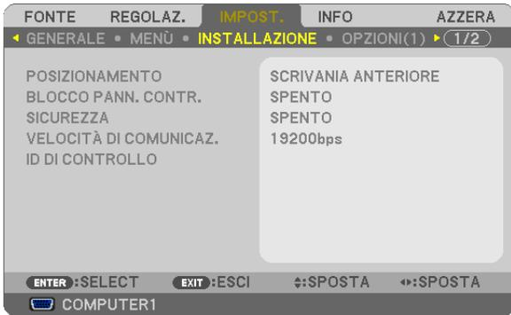
**Selezione dell'orientamento del proiettore [POSIZIONAMENTO]**
