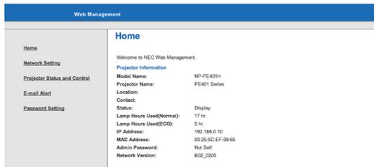
4. Aprire "Projector Status and Control (Stato e controllo proiettore)" per controllare il proiettore.
