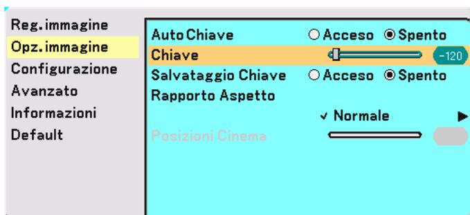
*NOTA: la funzione di correzione della distorsione trapezoidale può comportare la visualizzazione leggermente sfocata di un'immagine poiché la correzione viene eseguita elettronicamente.*
