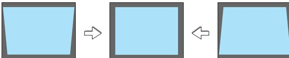
*NOTA: L'angolo della correzione trapezoidale automatica e manuale deve essere inferiore a 30 gradi, a seconda del tipo di segnali e dei rapporti di aspetto.*
