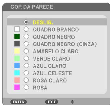
Esta função permite uma rápida correcção de adaptação de cor em aplicações em que o material do ecrã não é branco.
