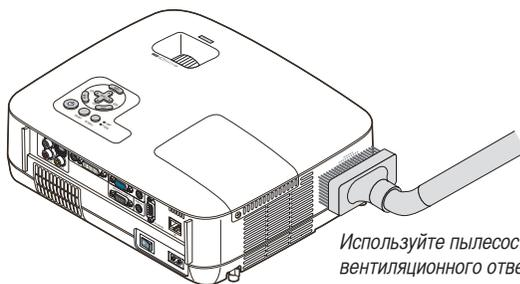
Используйте пылесос для чистки вентиляционного отверстия на корпусе проектора.
