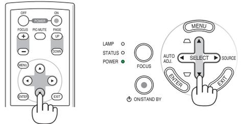
3. Pulse el botón ENTER en el mando a distancia o en la cubierta del proyector para seleccionar un submenú o elemento.
