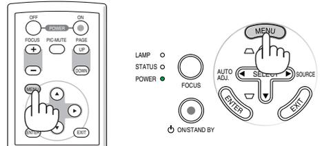
2. Pulse los botones SELECT ▲▼ en el mando a distancia o en la cubierta del proyector para resaltar el ítem de menú que desea ajustar o seleccionar.
