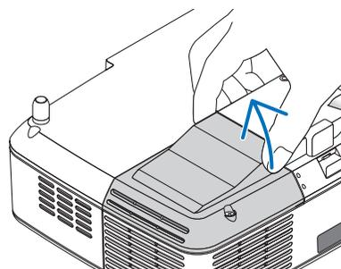
**3. Afloje los dos tornillos que aseguran el bastidor de la lámpara hasta que el destornillador Phillips gire libremente.**
