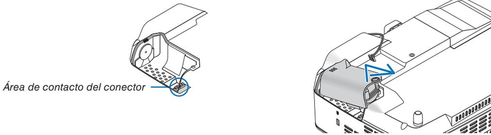
*NOTA: Mantenga limpia el área de contacto del conector. Si hay polvo o suciedad en el área de contacto del conector, limpie el conector.*
