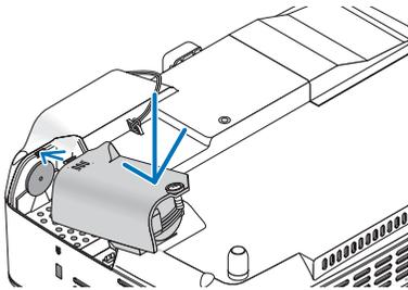
(2) Apriete el tornillo de la cubierta de la bomba de enfriamiento.
