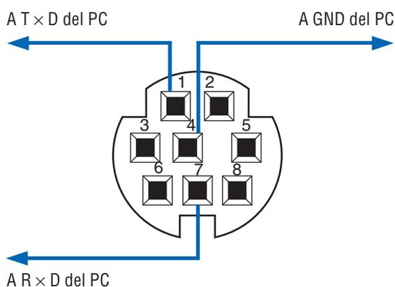
*NOTA: Los contactos 2, 3, 5 y 6 se utilizan en el interior del proyector.*
