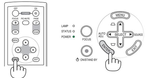
4. Utilice los botones SELECT ▲▼ del mando a distancia o de la cubierta del proyector para seleccionar el elemento que desea ajustar o configurar.
