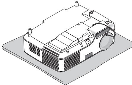
2. **Afloje el tornillo de la cubierta de la lámpara hasta que el destornillador gire libremente y, a continuación, retire la cubierta de la lámpara.**
