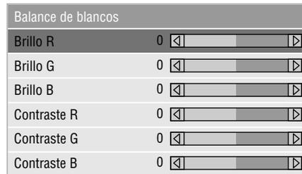
Utilice los botones ◀ ▶ para ajustar el balance de blancos. El brillo de cada color (RGB) se utiliza para ajustar el nivel de negro de la pantalla; el contraste de cada color (RGB) se utiliza para ajustar el nivel de blanco de la pantalla.
