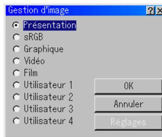
Cette option permet d'ajuster la teinte neutre pour le jaune, cyan ou magenta. Il y a 5 préréglages d'origine optimisés pour divers types d'images ou 4 réglages ajustables par l'utilisateur peuvent être réglés.
