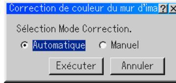
3. Utiliser la touche SELECT ▼ pour mettre "Exécuter" en surbrillance et appuyer sur la touche ENTER. La fonction "Automatique Correction de couleur du mur d'image" sera exécutée.
