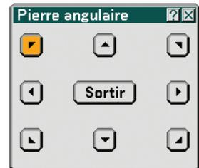
Le schéma indique que l'icône supérieure gauche (▲) est sélectionnée.
