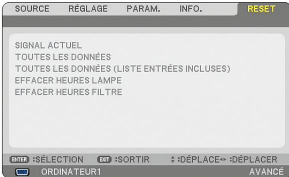
La fonction Reset vous permet de faire passer les réglages et paramétrages aux pré-réglages d'usine pour les sources par les méthodes suivantes :
