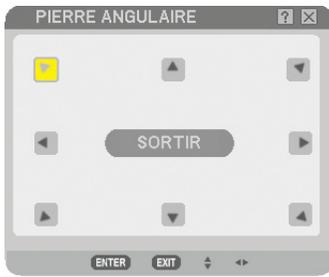
Cette option vous permet de corriger la distorsion trapézoïdale.
