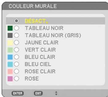
Cette fonction permet une correction rapide et adaptative de la couleur dans les applications où le matériau de l'écran n'est pas blanc.
