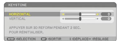
2. Appuyer sur la touche SELECT ▼ pour sélectionner [VERTICAL], puis utiliser SELECT ◀ ou ▶ afin que les côtés gauche et droit de l'image projetée soient parallèles.
