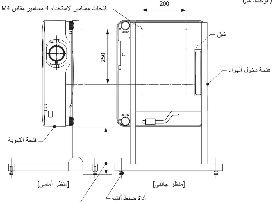
في حالة التركيب وفتحة طرد الهواء الساخن متجهة لأسفل، احرص على توفير مسافة 200 مم على الأقل بين فتحة طرد الهواء الساخن بجهاز العرض والأرضية.
