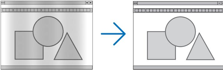
استخدم هذا العنصر للضبط الدقيق لصورة الحاسب الآلي أو إزالة أي نطاق عمودي قد يظهر. كما تقوم هذه الوظيفة بضبط تردد الساعة مما يزيل النطاق الأفقي من الصورة. وقد يلزم القيام بهذا الضبط عند توصيل جهاز الكمبيوتر لأول مرة.
