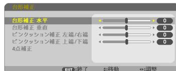
5. ▼ボタンを押して「4点補正」にカーソルを合わせ、決定ボタンを押す。
