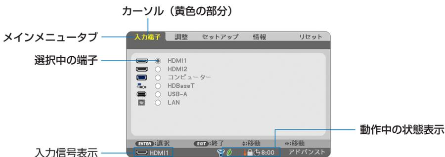
無線 LAN ユニットの動作中、エコモード設定、強制エコモード、本体キーロック中、8:00 オフタイマーの残り時間のアイコン
