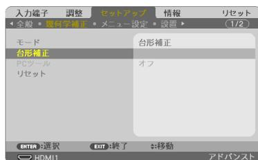
4. ▼ボタンを押して「台形補正」にカーソルを合わせ、決定ボタンを押す。
