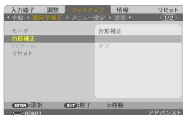
4. ▼ボタンを押して「台形補正」にカーソルを合わせ、決定ボタンを押す。
