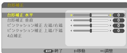
台形補正には、台形補正 水平、台形補正 垂直、ピンクッション補正 左端 / 右端、ピンクッション補正 端 / 下端、4点補正があります。
