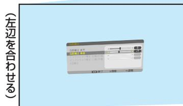
7. ▲ボタンを押して「台形補正 水平」にカーソルを合わせ、◀ / ▶ボタンを押して上下の辺を平行にする。
