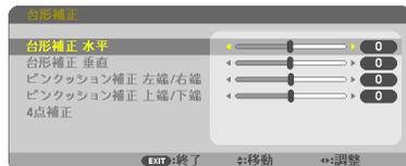
5. ▼ボタンを押して「台形補正 垂直」にカーソルを合わせ、◀ / ▶ボタンを押して左右の辺を平行にする。
