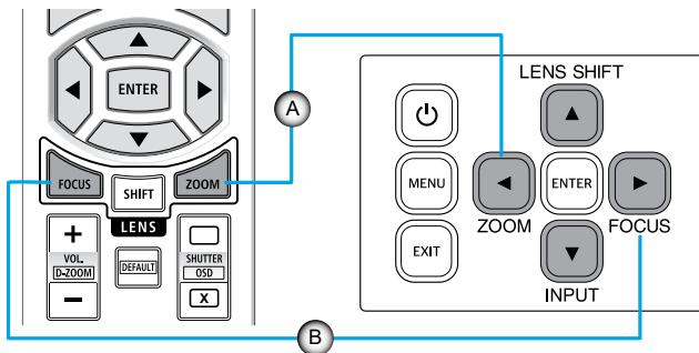
**참고:** 프로젝터가 테스트 패턴을 30분 이상 투사한 상태에서 초점 조정을 수행하는 것이 좋습니다. 테스트 패턴은 50 및 66 페이지를 참조하십시오.
