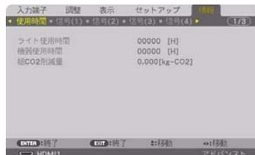
「今回のCO<sub>2</sub>削減量」は電源を入れてエコモードに切り替わってから電源を切るまでのCO<sub>2</sub>削減量 (g) を、電源オフ時に表示される電源オフ確認メッセージ内に表示します。
