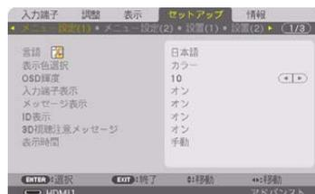
3. ▶ ボタンを押して「設置 (2)」にカーソルを合わせる。
