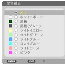
映像を投写する面がスクリーンではなく、部屋の壁などの場合、メニューから壁の色に近い項目を選択すると、壁の色に適応した色合いに補正して投写できます。
