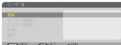
ユーザー 1、ユーザー 2、ユーザー 3 の 3 種類のアカウントを登録できます。「パスコード」を設定すると各ユーザーの「登録」が有効になります。「登録」でアカウントを登録すると、「ユーザー名変更」「パスワード変更」「有効」「削除」が選択可能になります。
