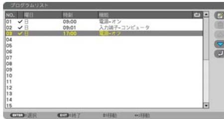
曜日や時刻を設定することにより、本機の電源オン／スタンバイや映像信号の切り替え、およびライトモードの切り替えを自動で行うことができます。たとえば、上の画面の設定では、日曜日の9時に電源がオンになり、9時1分にコンピューターの画面に切り替わり、17時に電源がスタンバイ状態になります。
