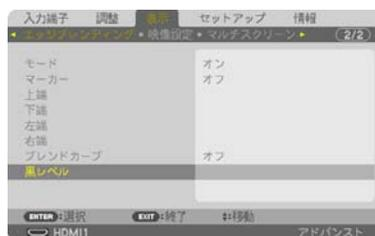
2. ◀ / ▶ ボタンで調整する箇所を選択し、◀ / ▶ ボタンで黒レベルを調整する。
