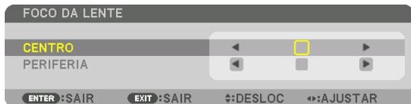
Pressione os botões ◀▶ para ajustar o foco. De outro modo, pressione e segure o botão CTL e, em seguida, pressione o botão VOL./FOCUS +/- no controle remoto.
