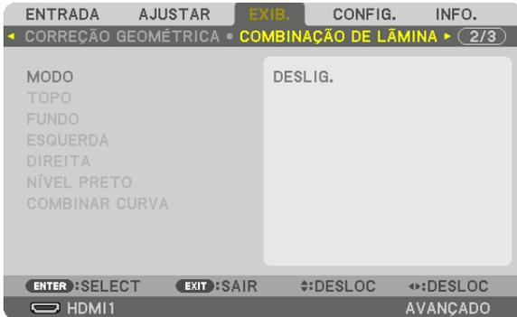
Isto ajusta as bordas (limites) da tela de projeção ao projetar vídeos de alta resolução usando uma combinação de diversos projetores nas posições para cima, para baixo, esquerda e direita.
