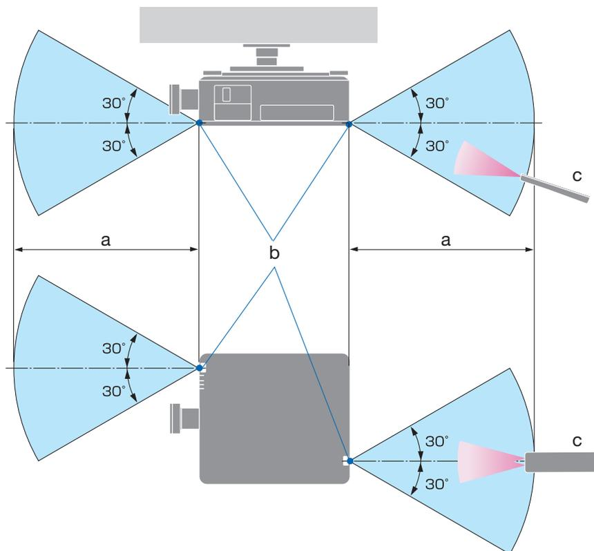
a: 7 m / b: Sensore del telecomando sul proiettore / c: Telecomando
