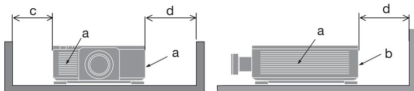
a: bocchetta di aspirazione/b: bocchetta di scarico/
