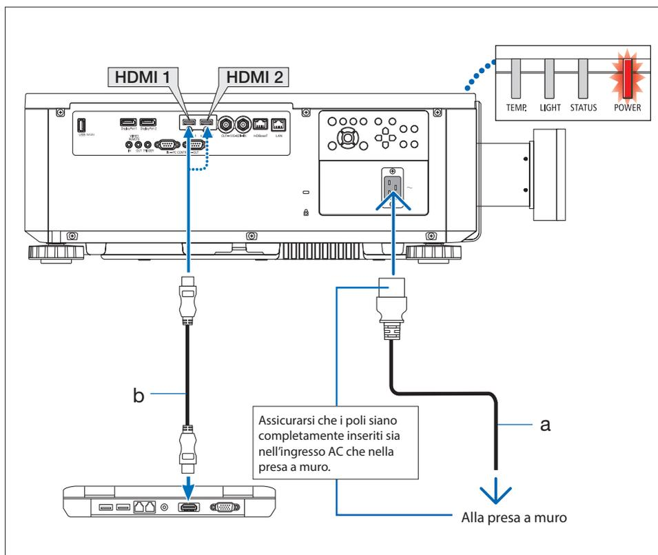
a: Cavo di alimentazione (in dotazione) /b: Cavo HDMI (non in dotazione)
