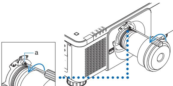
2. **Premendo fino in fondo il tasto di sgancio LENS sul pannello anteriore del proiettore, ruotare in senso antiorario l'obiettivo.**
