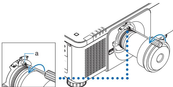
2. 完全按下投影機前面板上的 LENS 釋放按鈕，同時逆時針轉動鏡頭。
