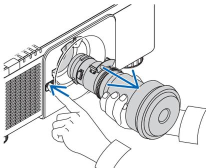
若要將防塵蓋安裝至投影機，請找出防塵蓋下端的卡扣並將它放入投影機的開口，使三角形標記(▽)的點朝下(下圖中的①)，然後抓住把手(下圖中的②)並將防塵蓋的上端推向投影機，將卡扣放入插槽中。
