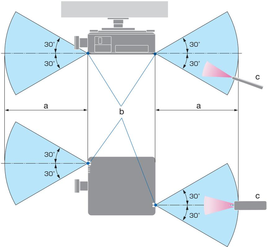
a : 7 m/276" / b : 投影機機殼上的遙控感測器 / c : 遙控器
