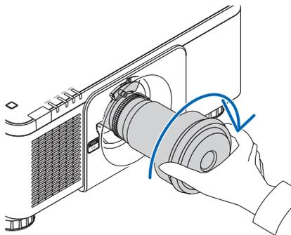
5. 使用球頭六角扳手起子順時針轉動鏡頭單元螺絲Ⓐ以鎖緊。
