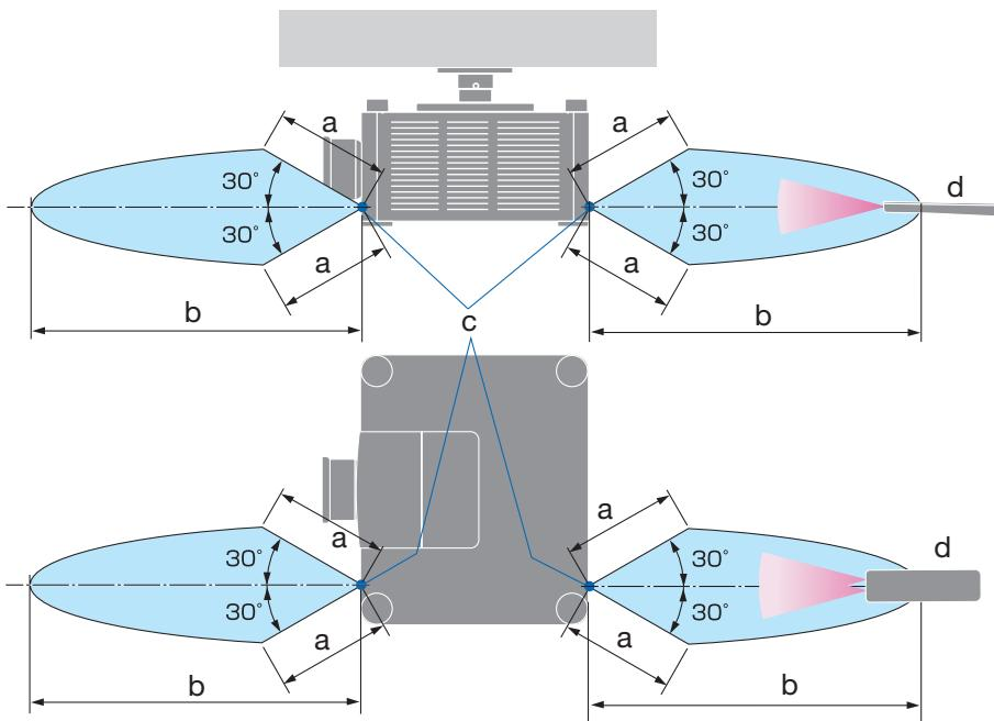
a: 7米 / b: 20米 / c: 投影机机箱上的遥控传感器 / d: 遥控器
