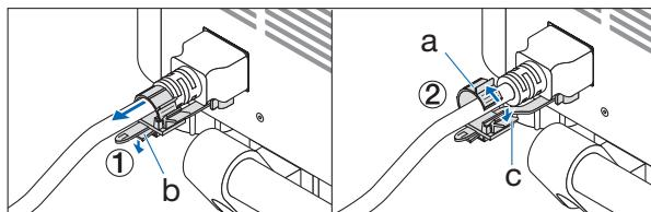
a: 夹具 / b: 旋钮（电源线固定器） / c: 旋钮（夹具）
