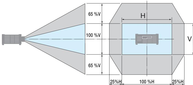
符号说明：V代表垂直（投射影像的高度），H代表水平（投射影像的宽度）。
