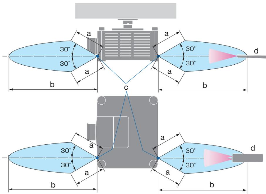
a : 7 m/276" / b : 20 m/787" / c : Télécommande sur le boîtier du projecteur / d : Télécommande
