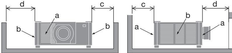
a : Entrée d'air / b : Évent d'échappement / c : 20 cm/8" ou plus / d : 30 cm/12" ou plus
