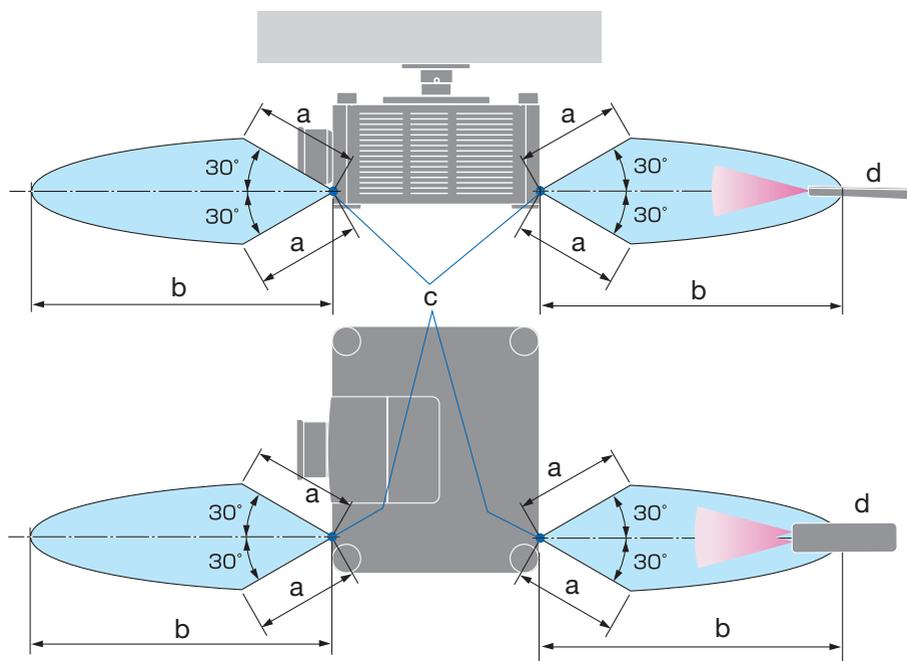
a: 7 m/276"/b: 20 m/787"/c: Sensore remoto sul proiettore/d: Telecomando
