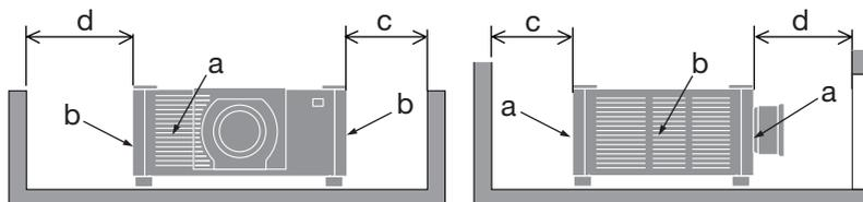
a: bocchetta di aspirazione/b: bocchetta di scarico/
