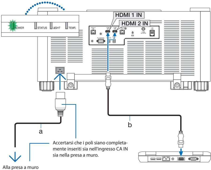
a: Cavo di alimentazione (in dotazione)/b: Cavo HDMI (non in dotazione)
