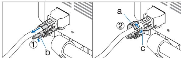
a: Morsetto/b: Manopola (fermo del cavo di alimentazione)/c: Manopola (morsetto)
