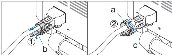
a：夾持器 / b：旋鈕（電源線止動器）/ c：旋鈕（夾持器）
