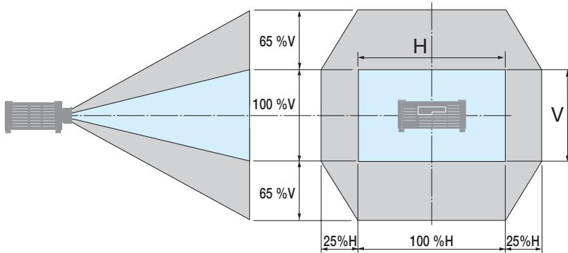
符號說明：V表示垂直（投射影像的高度），H表示水平（投射影像的寬度）。
