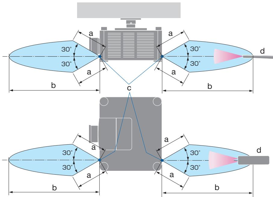
a : 7 公尺/276英吋 / b : 20 公尺/787英吋 / c : 投影機機箱上的遙控感應器 / d : 遠程控制
