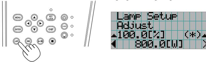
**TIPP** Drücken Sie die ENTER-Taste, um die Anzeige zwischen „Lamp Setup (Adjust)“ und „Lamp Setup (Lamp Mode)“ umzuschalten. Beachten Sie, dass Sie den Lampenmodus-Einstellbildschirm nicht benutzen können, während die Anzeige der LAMP ON/OFF-Taste in Grün blinkt (Seite 66), weil die Lampe nicht ausgeschaltet und der Lampenmodus nicht eingestellt werden kann.
