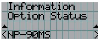
← Zeigt den Verbindungszustand des Geräts in Steckplatz an.
