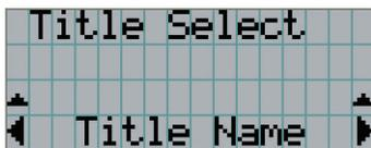
**5** Drücken Sie die LEFT/RIGHT-Tasten, um „Titel des zu projizierenden Signals“ auf dem LCD-Bildschirm anzuzeigen.
