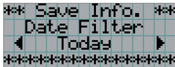
**TIPP** Wenn Sie während des Vorgangs die EXIT-Taste drücken, wird der Vorgang gestoppt, und die Anzeige kehrt zum normalen Bildschirm zurück.
