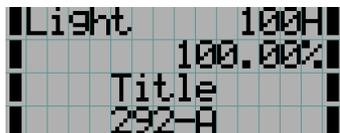
← Affiche le mode de la source lumineuse et la puissance de la source lumineuse (%).
