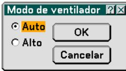
Esta opción le permite seleccionar entre dos modos de velocidad de ventilador: el modo Auto y el modo Alta velocidad.
