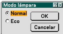
Esta función le permite seleccionar dos modos de brillo para la lámpara: Normal y Eco. La vida útil de la lámpara puede prolongarse en hasta 4000 horas si se utiliza el modo Eco. Al seleccionar el modo Eco disminuye el ruido del ventilador en comparación al modo Normal.
