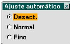
Esta función activa el modo Ajuste automático, en el cual la imagen RGB se puede ajustar de forma automática o manual (ajuste del ruido y la estabilidad de la imagen). Puede realizar el ajuste automático de dos formas: Normal y Fino
