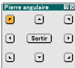
Cette option vous permet de corriger la distorsion trapézoïdale.
