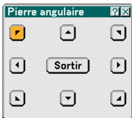
5. **Utiliser la touche SELECT ▲▼◀▶ pour sélectionner une icône qui pointe dans la direction dans laquelle le cadre de l'image projetée doit être déplacé.**
