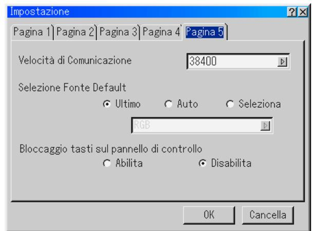
**Selezione della velocità di comunicazione [Velocità di Comunicazione]:**
