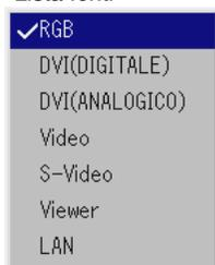
Premete e rilasciate rapidamente il tasto SOURCE sul proiettore per visualizzare la lista Fonte. Ad ogni pressione del tasto SOURCE, la fonte d'ingresso cambia nel seguente modo: "RGB" (Computer o DVD con uscita componente), "Video" (VCR, macchinetta fotografica per documenti o lettore LD), "S-Video", "DVI(DIGITALE)", "DVI (ANALOGICO)", "Viewer (diapositive sulla PC Card), o "LAN" (segnale senza fili trasmesso dal PC). Premete il tasto ENTER per visualizzare la fonte selezionata.
