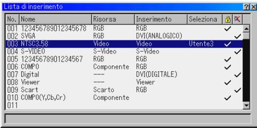
Visualizza la lista dei segnali di inserimento. Usate i tasti SELECT ▲▼ del telecomando o sul proiettore stesso per selezionare il segnale e premete il tasto ENTER sul telecomando o sul proiettore per visualizzare lo schermo Comando modifica inserimento.
