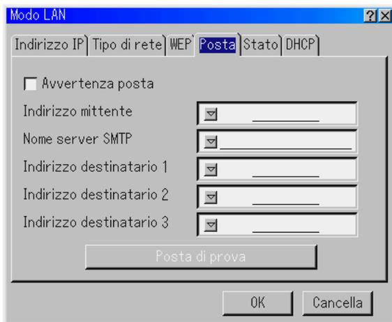
*NOTA: Alla funzione Avvertenza posta nel collegamento LAN senza fili, selezionate "Infrastruttura" per "Modalità" in "Tipo di rete". "Posta di prova" è disponibile solo quando c'è una scheda LAN nella fessura della PC Card del proiettore.*
