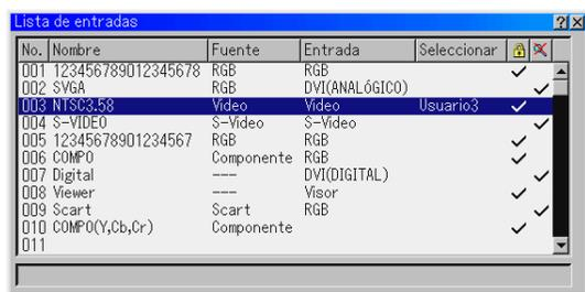
Muestra la lista de señales de entrada. Use los botones SELECT ▲▼ del mando a distancia o del proyector para seleccionar la señal y pulse el botón ENTER en el mando a distancia o en el proyector para visualizar la pantalla comandos de edición de entrada.
