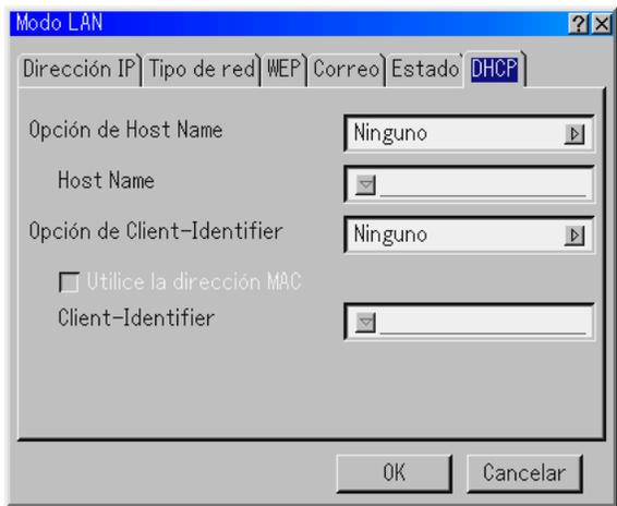
Dependiendo del entorno de red, puede resultar imposible adquirir una dirección de IP de un servidor DHCP. En ese caso, póngase en contacto con el administrador de la red para modificar los siguientes parámetros.
