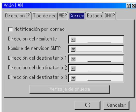
*NOTA: Para disponer de la función de notificación por correo en la conexión LAN, seleccione la opción "Infraestructura" para "Modo" en "Tipo de red". "Mensaje de prueba" sólo estará disponible si hay una tarjeta LAN insertada en la ranura para tarjetas PC del proyector.*
