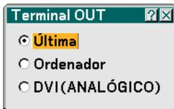
Esta opción le permite determinar que fuente RGB o componente se emite en el conector MONITOR OUT durante el modo de espera.
