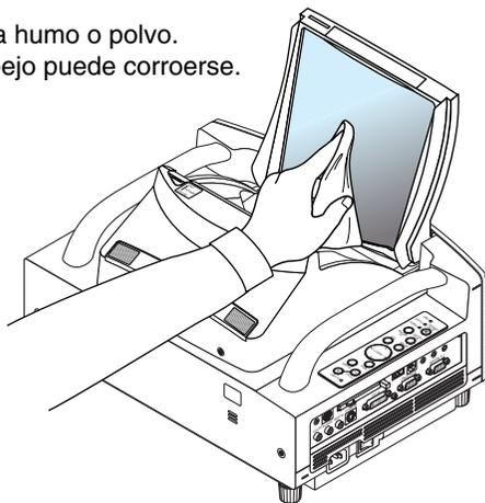
Si la superficie del espejo está cubierta de huellas o polvo, elimínelos con la bayeta que se incluye.
