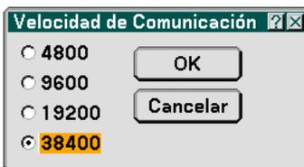
Esta función ajusta la velocidad de línea en baudios del puerto PC Control (Mini DIN de 8 contactos). Admite velocidades de transferencia de datos de 4800 a 38400 bps. El ajuste por defecto es 38400 bps. Seleccione la velocidad de transmisión en baudios apropiada para el equipo a conectar (dependiendo del equipo, puede ser preferible elegir una velocidad en baudios menor en caso de que se utilicen cables largos).
